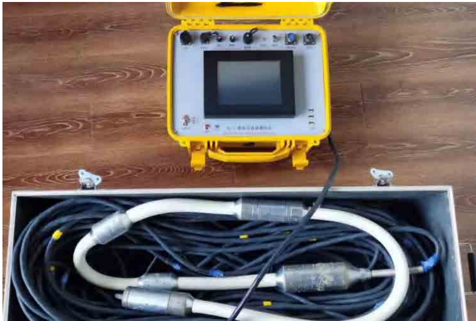
图 2 XG-I 型波速测井仪
