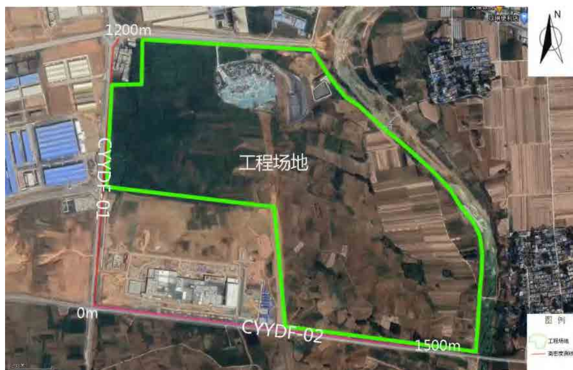
图 5.4-1 电法测线位置示意图
