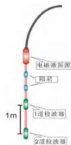
图 3 探头组成示意图
