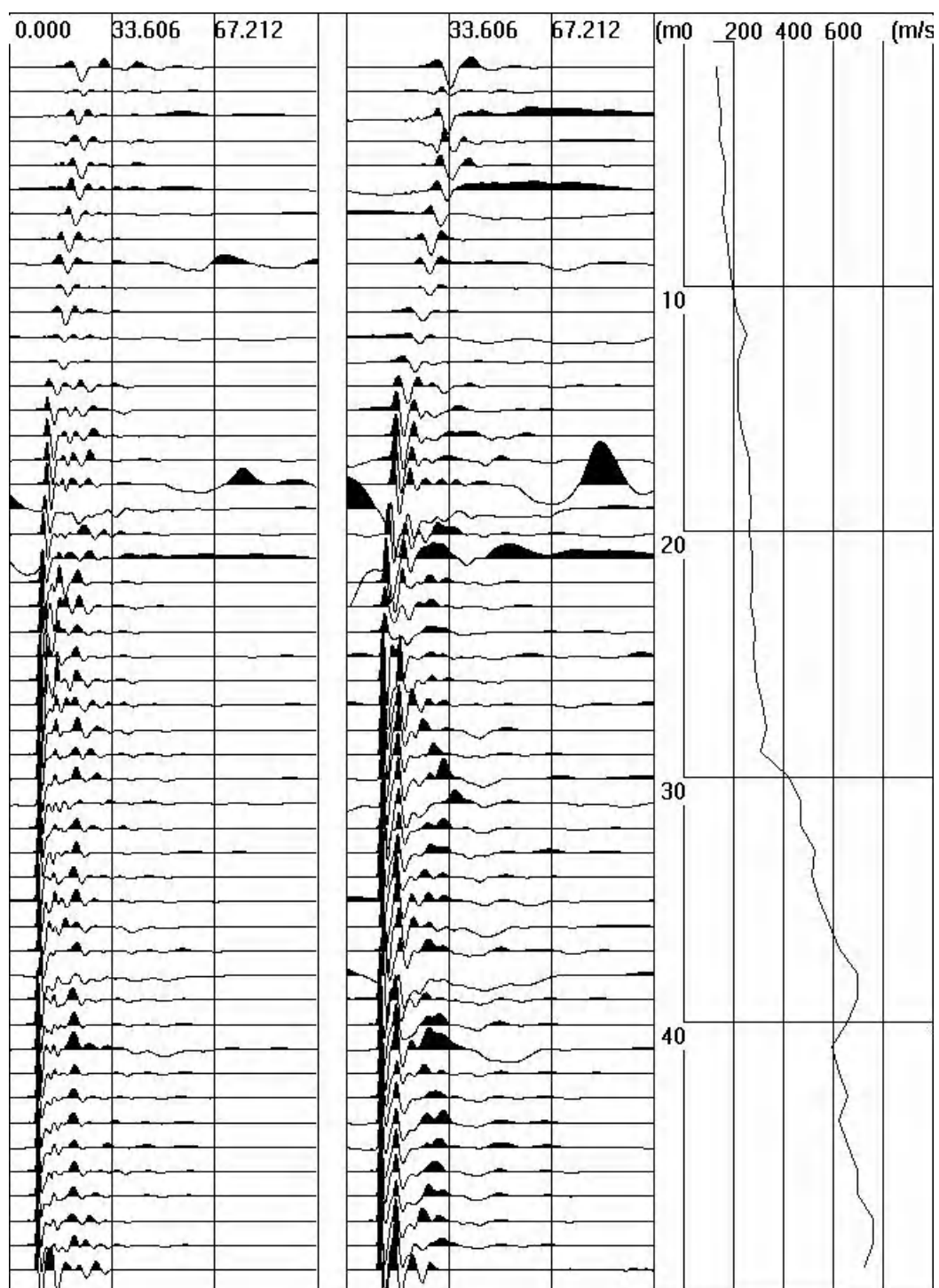
图 5.2-21 工程场地 10 号孔波速测试波列图
