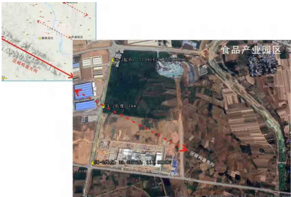
图 5.4-3 浅层地震勘探线布置示意图
